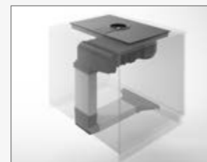
Beispiel für Umluftversion bei tiefem Schrank Example of filtering mode configuration with deep cabinet
